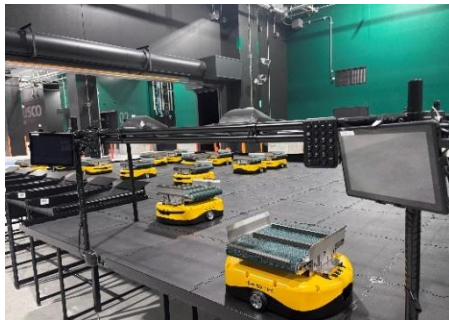
当社初導入の t-Sort [平面型ソーティングロボットシステム]
