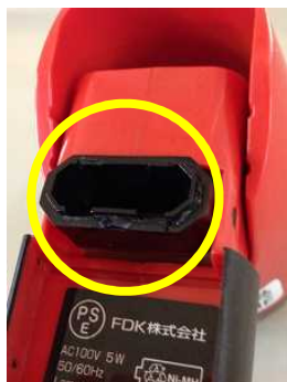
差し込みプラグ抜け部分拡大
