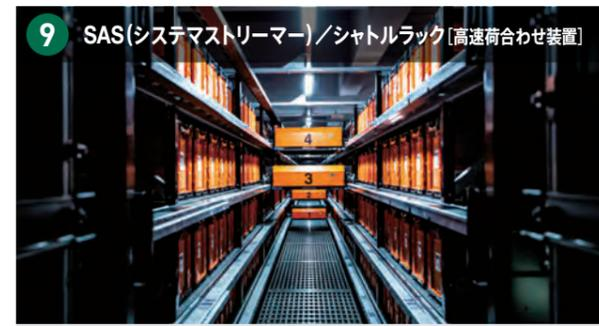
自動倉庫型高速荷合わせ装置。複数の注文のニアワセ(荷合わせ)と仕分けを同時にこなす。仕分けや搬送の手間と時間を削減。
