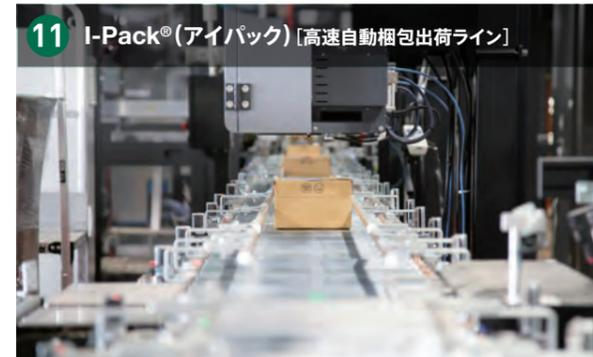
納品書の挿入、梱包、荷札の貼付け作業を高速で行う出荷ライン。自動化により梱包時間短縮・品質向上につながり、ユーザー様直送強化の要になっている(P.51, 56参照)。
