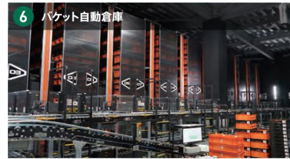
一商品の在庫数量が比較的少ない小・中物商品をバケット(コンテナ)に高密度に保管。クレーンがバケットを自動搬送する。在庫の高密度化と入出庫の省人化、効率化を図る。
