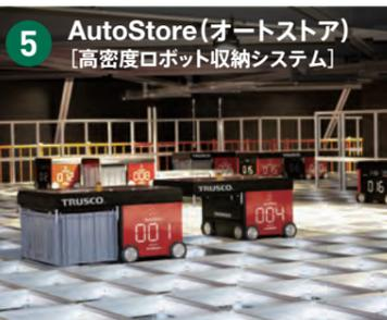
床から天井近くまでピン(コンテナ)を積み上げることで空間効率を最大化できる設備。ロボットがコンテナ運搬を行い入出庫作業の効率化・省人化を図る。
