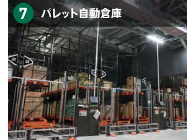
大物商品や重量物などをパレットで収納。大型クレーンが自動搬送することにより、スピーディーかつ正確に作業が可能。
