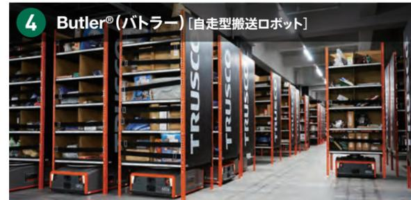
自走型搬送ロボットが棚を持ち上げ、作業者のもとへ移動させる。作業者の歩く時間を削減し入出庫を効率化。
