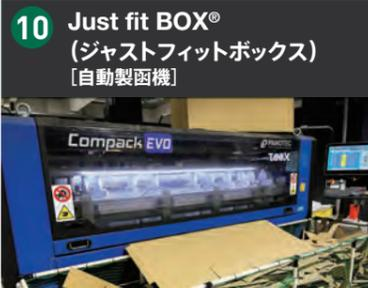
異形物など梱包が難しい商品の3辺寸法を読み取り、商品に合ったサイズの箱を作成。作業効率と梱包品質向上、資材削減に効果を発揮します。
