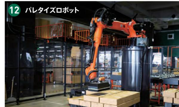
荷積みや荷下ろしの作業を行うロボット。主に、I-Pack®で梱包された商品の仕分けに活用し、省人化や正確性、作業品質の向上につなげている。
