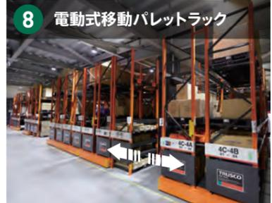
移動可能なパレットラックにすることで倉庫内の通路を削減し、保管スペースを拡大。重量物の格納効率を高める。
