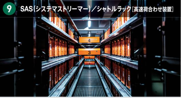
自動倉庫型高速荷合せ装置。複数の注文のニアワセ(荷合せ)と仕分けを同時にこなす。仕分けや搬送の手間と時間を削減。
