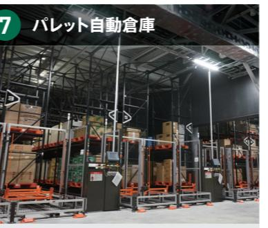
空間を有効活用し、大物商品や重量物などを樹脂パレットで効率よく保管できる。大型クレーンが自動搬送することにより、スピーディーかつ正確に作業が可能。
