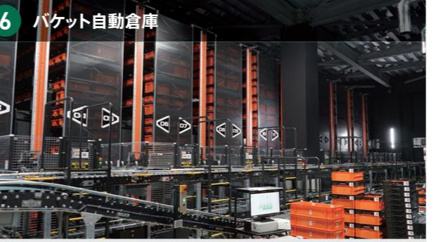
多品種かつ一商品の在庫数量が比較的小ない小・中物商品をバケット(コンテナ)に高密度に保管。クレーンがバケットを自動搬送する。多くの商品を少人数で効率的に管理。
