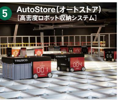
床から天井近くまでBIN(樹脂コンテナ)を積み上げることで空間効率を最大化できる設備。ロボットがコンテナ運搬を行うことで出入庫作業の効率化・省人化を図る。
