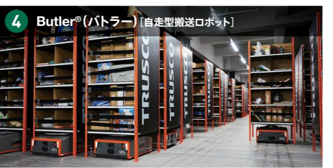
自走型搬送ロボットが棚を持ち上げ、倉庫内の作業者のもとへ移動させる。作業者の歩く時間を削減し入出庫を効率化。
