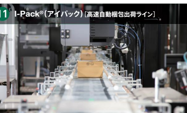
納品書の挿入、梱包、荷札の貼付け作業を高速で行う出荷ライン。自動化により梱包時間短縮・品質向上につながり、ユーザー様直送強化の要になっている(P.52参照)。
