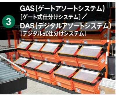
該当するコンテナの蓋が開き(またはライトが光り)、そこに商品を入れるだけの商品仕分け設備。人による仕分けミスがなくなり、精度・スピードが向上する。
