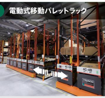
移動可能なパレットラックにすることで倉庫内の通路を削減し、保管スペースを拡大。重量物の格納効率を高める。
