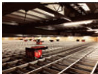
AUTO STORE (オートストア) ロボットがコンテナの出し入れを行う、 自動倉庫型ピッキングシステム
