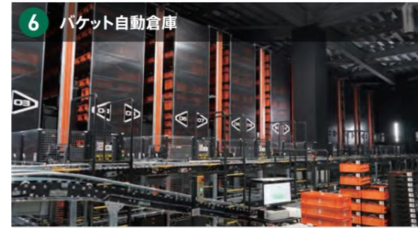
一商品の在庫数量が比較的少ない小・中物商品をバケット(コンテナ)に高密度に保管。クレーンがバケットを自動搬送する。在庫の高密度化と入出荷の省人化、効率化を図る。
