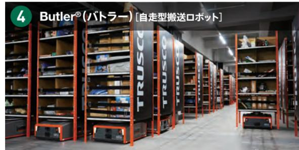
自走型搬送ロボットが棚を持ち上げ、作業者のもとへ移動させる。作業者の歩く時間を削減し入出荷を効率化。
