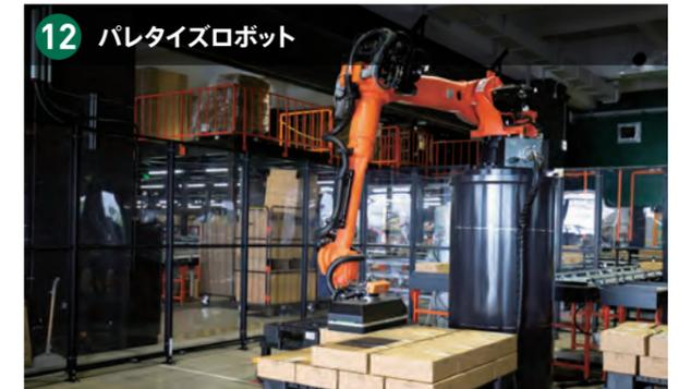
荷積みや荷下ろしの作業を行うロボット。主に、I-Pack®で梱包された商品の仕分けに活用し、省人化や正確性、作業品質の向上につなげている。
