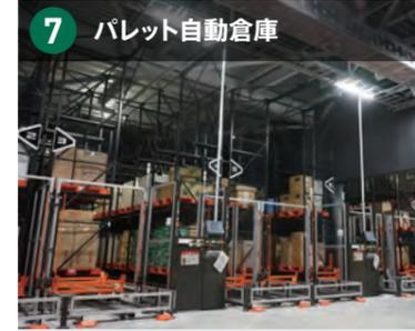
大物商品や重量物などをパレットで収納。大型クレーンが自動搬送することにより、スピーディーに作業が可能。
