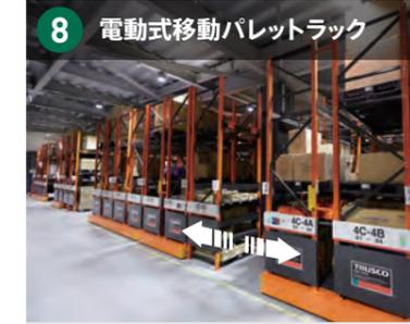
移動可能なパレットラックにすることで倉庫内の通路を削減し、保管スペースを拡大。重量物の格納効率を高める。
