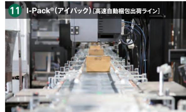
納品書の挿入、梱包、荷札の貼付け作業を高速で行う出荷ライン。自動化により梱包時間短縮・品質向上につながり、ユーザー様直送強化の要になっている(P.52,60参照)。
