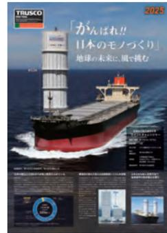
2025年「TRUSCO がんばれポスター」硬翼帆式 風力補助推進システム「ウインドチャレンジャー」
