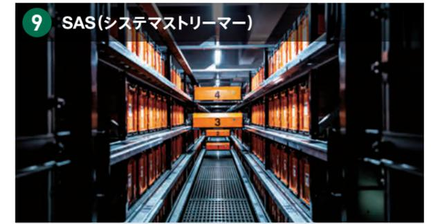
自動倉庫型高速荷合わせ装置。複数の注文のニアワセ(荷合わせ)と仕分けを同時にこなす。仕分けや搬送の手間と時間を削減。
