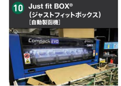
異形物など梱包が難しい商品の3辺寸法を読み取り、商品に合ったサイズの箱を作成。作業効率と梱包品質向上、資材削減に効果を発揮します。
