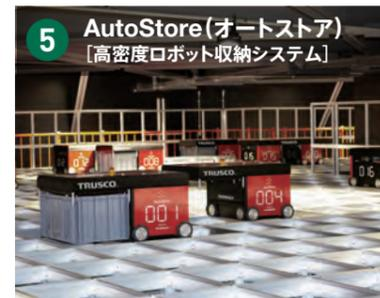
床から天井近くまでピン(コンテナ)を積み上げることで空間効率を最大化できる設備。ロボットがコンテナ運搬を行い入出荷作業の効率化・省人化を図る。
