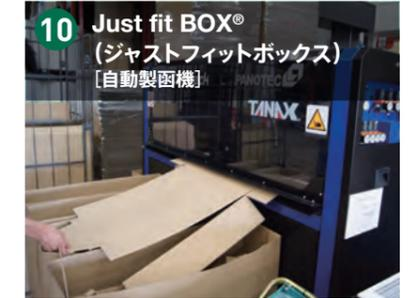
**10 Just fit BOX® (ジャストフィットボックス) [自動製函機]**
