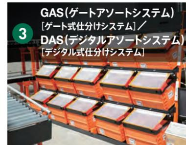
**3 GAS (ゲートアソートシステム) [ゲート式仕分けシステム] / DAS (デジタルアソートシステム) [デジタル式仕分けシステム]**
