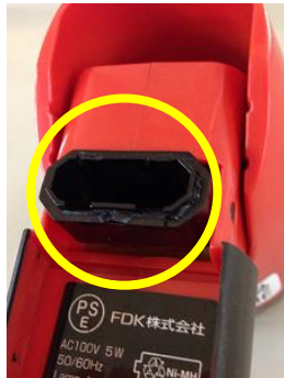
差し込みプラグ抜け部分拡大
